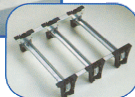
DIN lišty sú výškovo nastaviteľné pre štandardné prístroje (48 až 75 mm). Môže sa použiť aj montážny rám pre zjednotenie výšky
