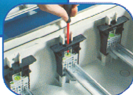
DIN lišty sú výškovo nastaviteľné pre štandardné prístroje (48 až 75 mm). Môže sa použiť aj montážny rám pre zjednotenie výšky
